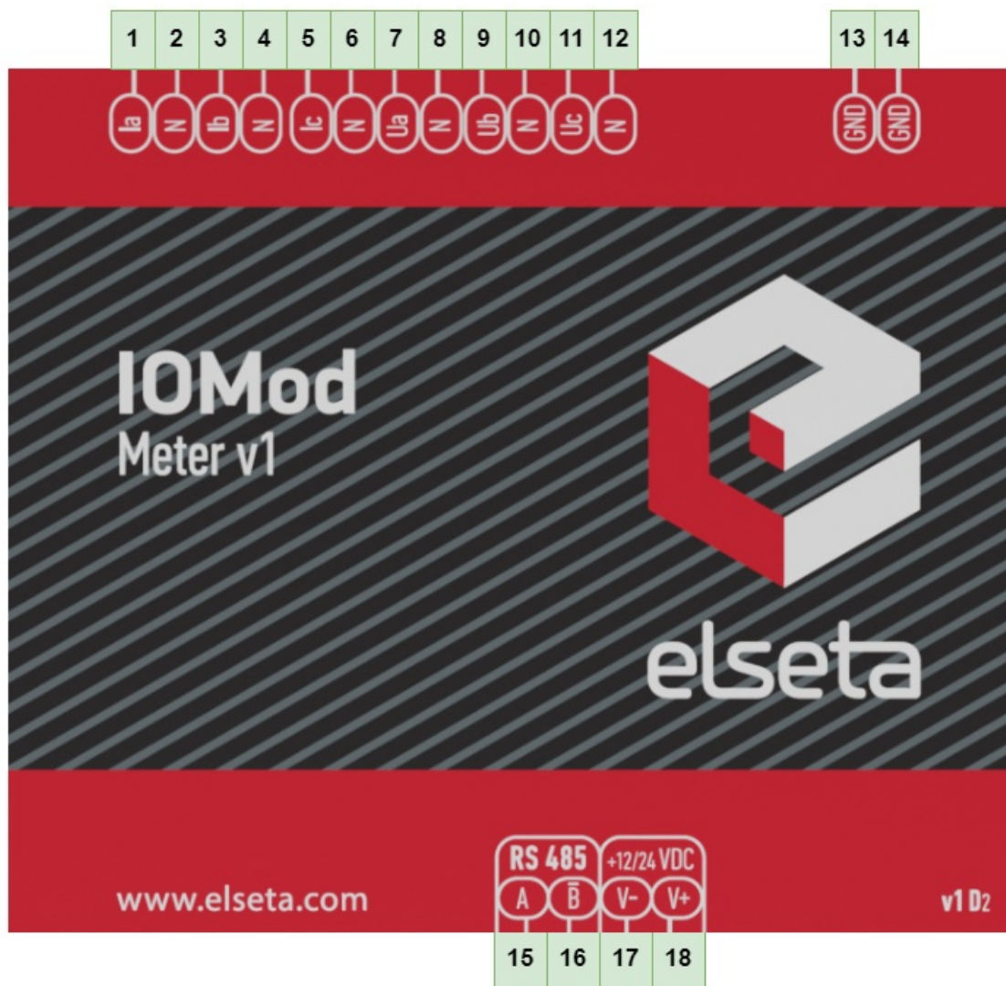
Fig. 2.2.1 IOMod Meter terminal diagram
