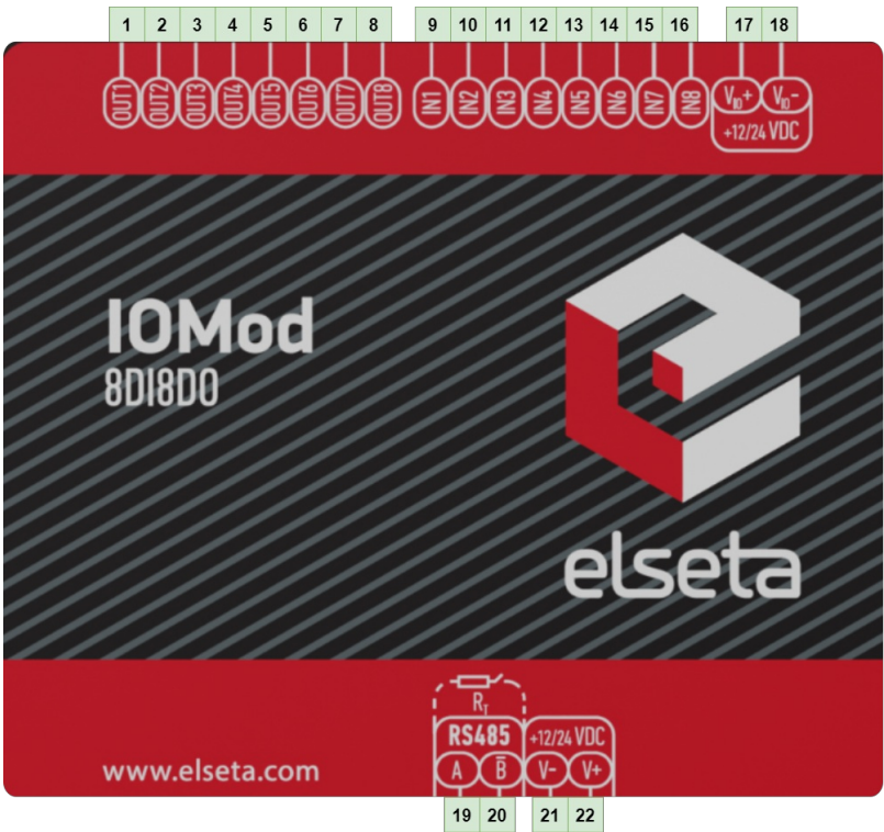
Fig. 2.2.1 IOMod 8DI8DO terminal diagram
