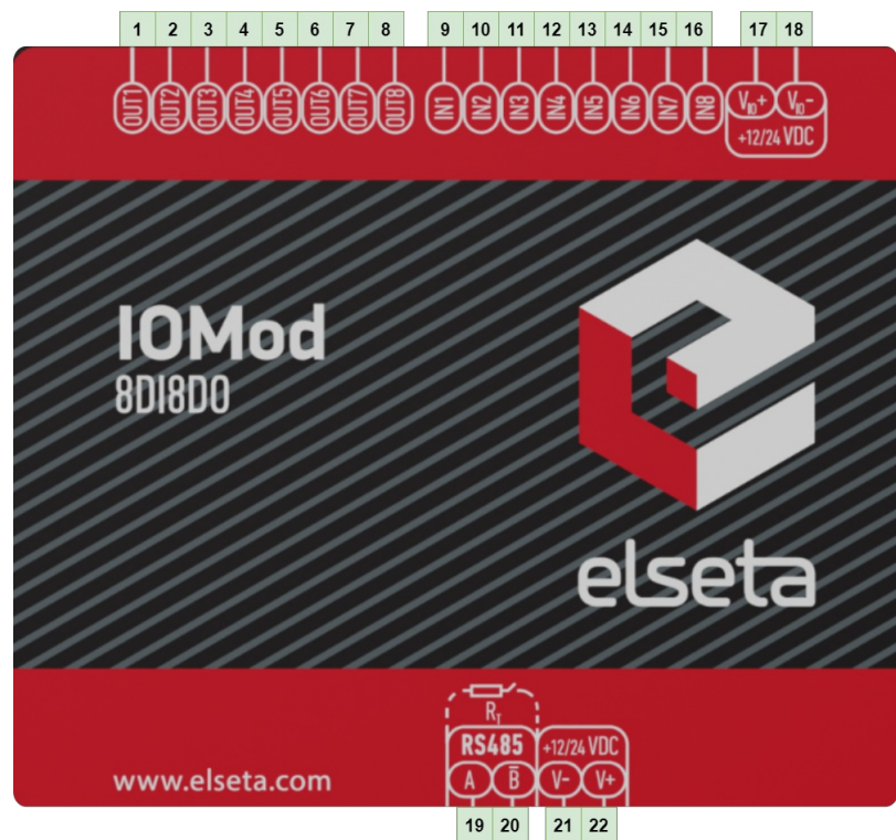
Fig. 2.2.1 IOMod 8DI8DO terminal diagram
