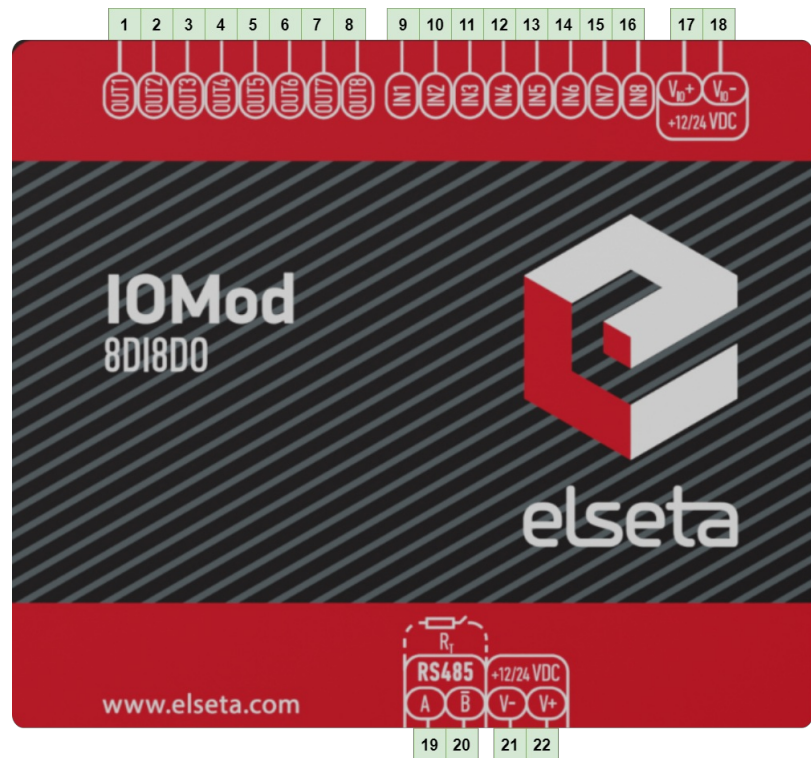
Fig. 2.2.1 IOMod 8DI8DO terminals diagram
