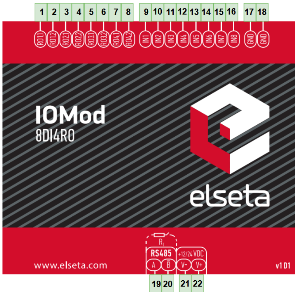
Fig. 2.2.1 IOMod 8DI4RO terminal diagram
